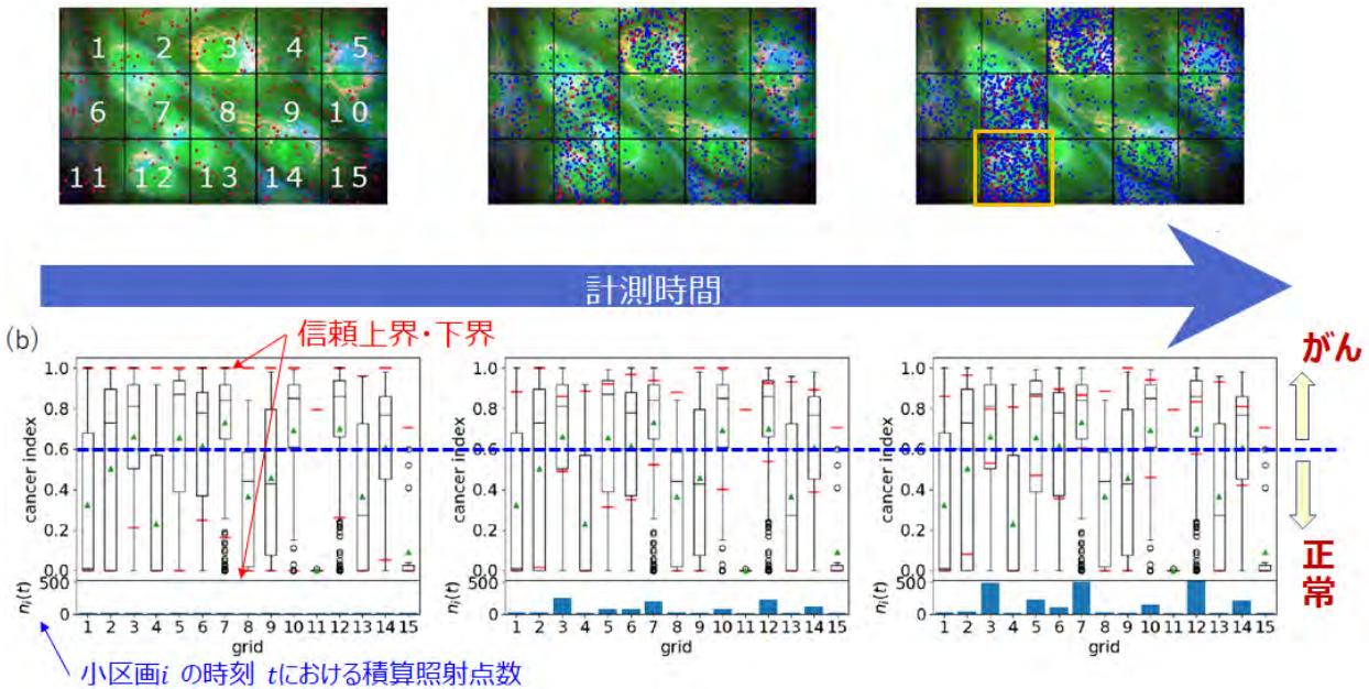
**図3.** 甲状腺濾胞がん細胞株（がん）のラマンAI計測のシミュレーション結果。上図のラマン分光画像は事前にフルスキャンして得られたもの。シミュレーションではどこに細胞が存在するかなどの情報は与えず、照射した点（赤点）、それまでに照射した点（青点）上のラマンスペクトルだけを用いて、自律的かつ効率的にがんの確率が高い小区間を計測。
