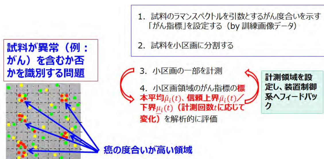
図 2. オン・ザ・フライ ラマン顕微鏡の考え方：計測しつつデータ解析を行い、どの部分をどの程度照射すべきか各々の試料に依存し、自律的に学びながら計測を迅速化する。
